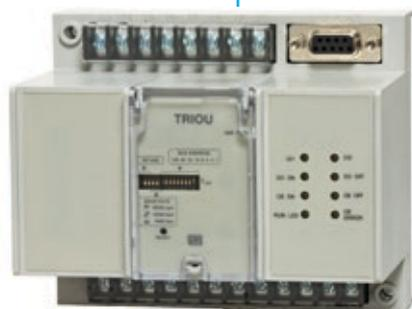
El módulo de comunicación es un accesorio opcional que posee un conjunto de I/O que permite maniobrar el interruptor remotamente. Todos los interruptores ABW y ABWC, con las unidades de protección A y P, presentan la opción de comunicación en red, que permite al usuario verificar el estado del interruptor o maniobrarlo a través de la red Modbus o Profibus.
