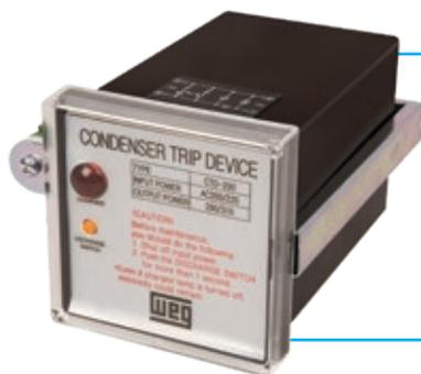
Este dispositivo mantiene la posibilidad de apagar el interruptor por comando eléctrico en caso de falta de tensión de comando. Su actuación se da por medio de la descarga de un condensador sobre la bobina de apertura, siendo esto posible dentro del período indicado en la tabla abajo. Posee lámpara de señalización de carga del condensador y un botón para descargarlo. Instalación en la puerta del tablero.
